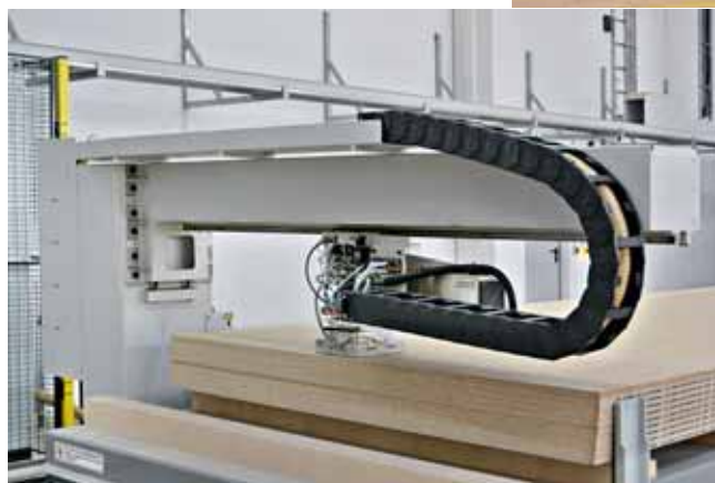
Links: Auf der Beladeseite des Bearbeitungszentrums wurde ein Hubtisch mit Druckereinheit realisiert. Rechts: der Abnahmetisch
