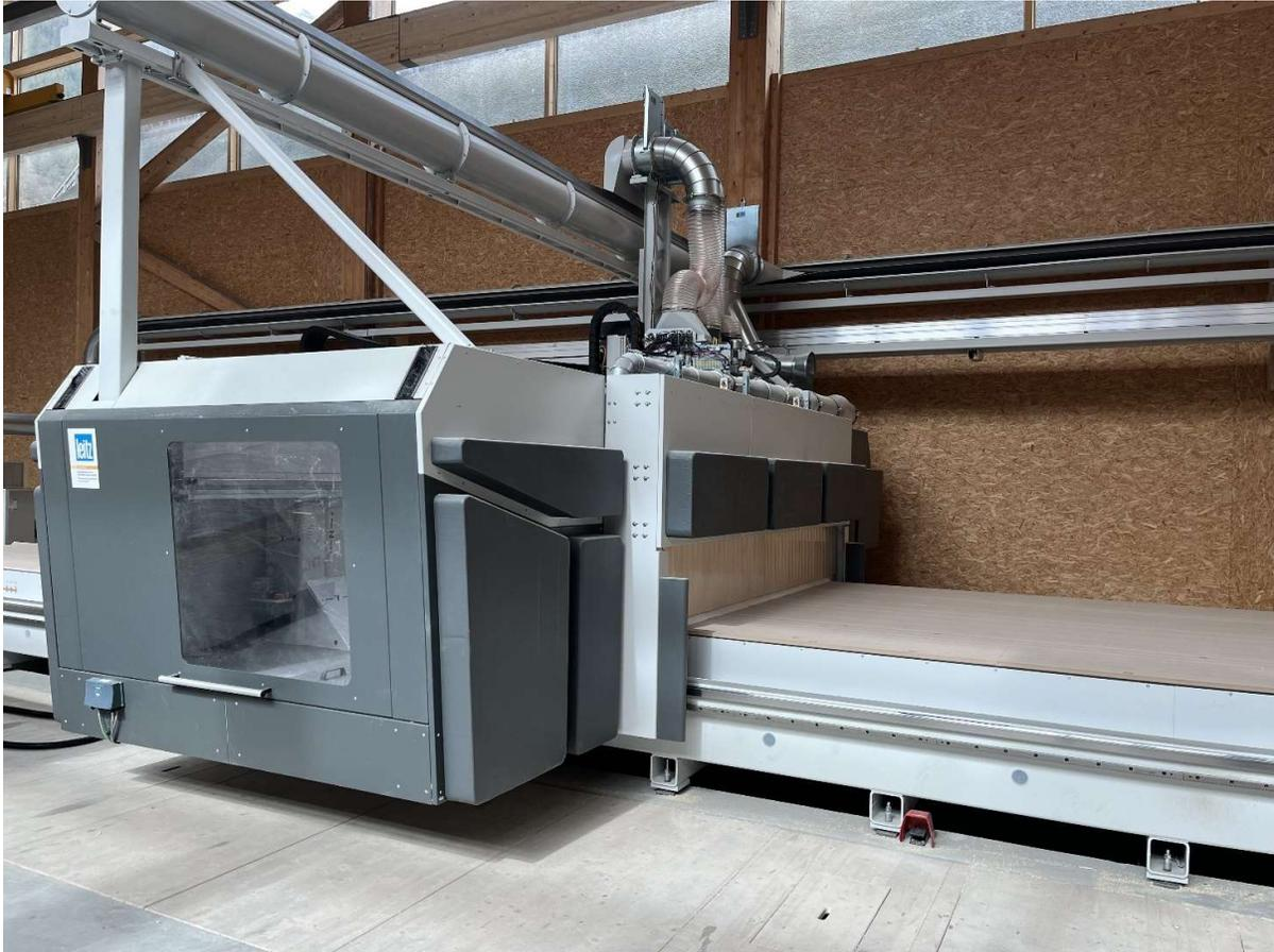
Bei Brawand kommt eine Maschine aus dem Hause **MAKA Systems GmbH** mit 14 Meter langem Vakuumrastertisch und 28 Einzel ansteuerbaren Vakuumfelder zum Einsatz. Zur 5-Achs Bohr- und Frässpindel gesellt sich ein Bohrkopf mit 40 einzeln abrufbaren Bohrspindeln.
